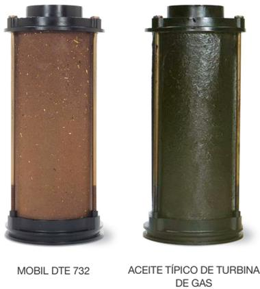
Durante la prueba de servicio simulado Mobil DTE 732 demostró un control superior a la formación de depósitos.
